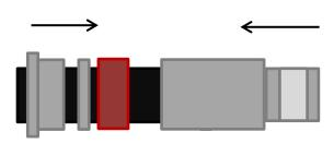
Innenstift (7) über Innenleiter schieben (rastet in Kunststoffring ein!). Anschließend über Lötloch bei 340°C mit Lötzinn verlöten.
