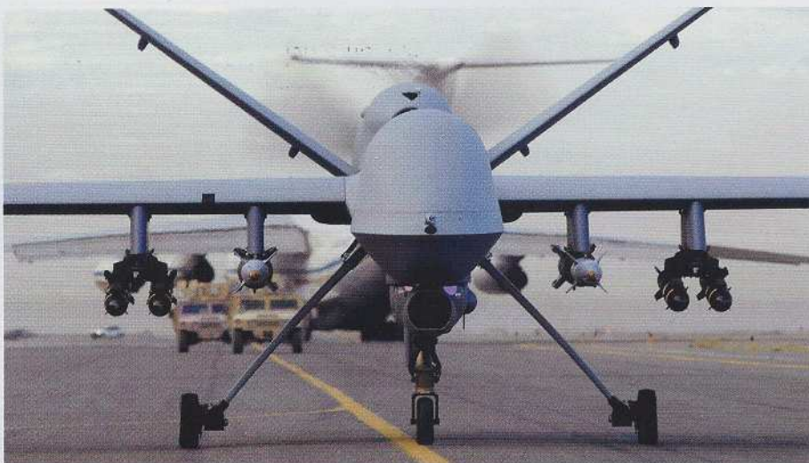
MQ-9B REAPER mit laser- und GPS-gelenkten Abwurfwaffen HELLFIRE II und GBU-49 (GBU-12) Paveway II DMLGB. (Bild: USAF)
