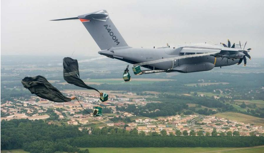
Joint Precision Airdrop (JPADS) – Materialabwurf aus dem Airbus A400M
