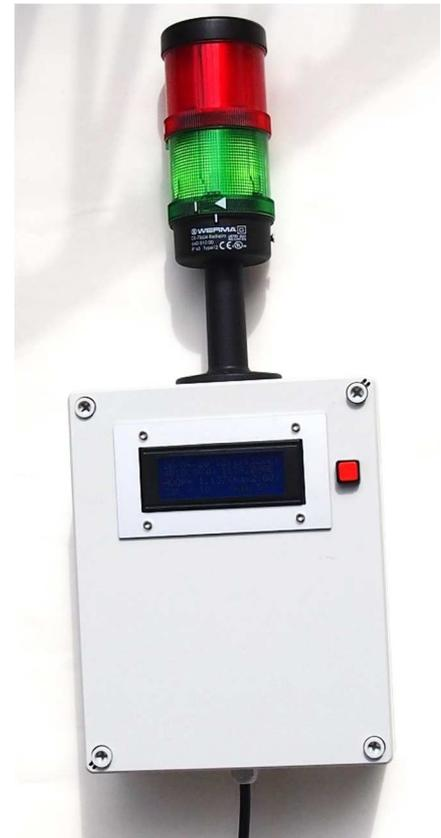
Das System kann auch kundenspezifisch zur Signalanalyse von GPS, Glonass und Galileo, konfiguriert werden. Je nach Anforderung wie Boden, Luft oder Marine können weitere Qualitätswerte wie z.B. GDOP (Satellitengeometrie), PDOP oder C/N eingebunden werden. Ebenso kann das System auf den Standort eingemessen werden und dient dann vor allem der Sicherheit gegen Jamming oder Spoofing. Die Status-Abfrage der einzelnen Stationen kann optional über ein Webinterface erfolgen.
